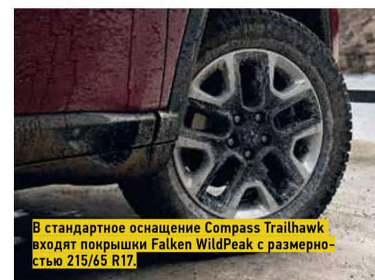
В стандартное оснащение Compass Trailhawk входят покрышки Falken WildPeak с размерностью 215/65 R17.
