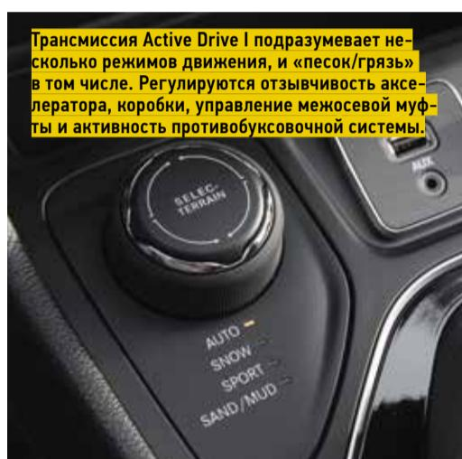
Трансмиссия Active Drive I подразумевает несколько режимов движения, в том числе «песок/грязь» в том числе. Регулируются отзывчивость акселератора, коробки, управление межосевой муфтой и активность противобуксовочной системы.
