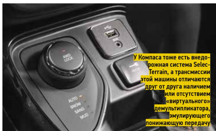
У Компаса тоже есть внедорожная система Select-Terrain, а трансмиссии этой машины отличаются друг от друга наличием или отсутствием «виртуального» демультипликатора, эмулирующего понижающую передачу
